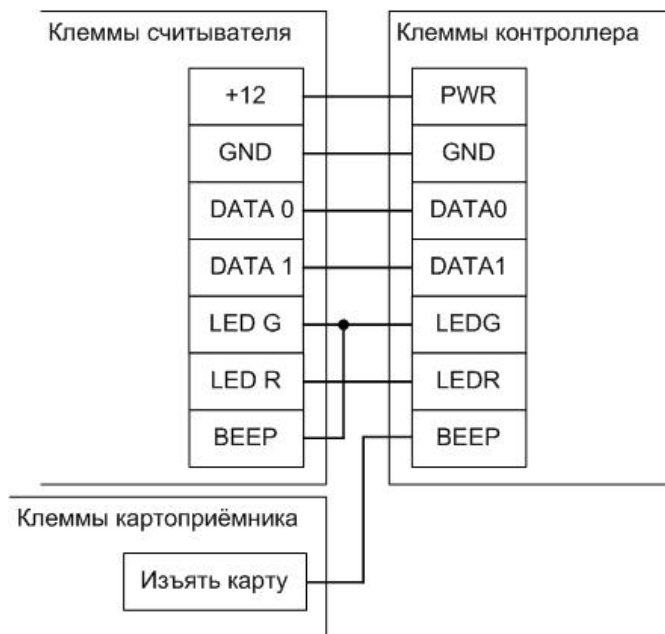
Пример подключения считывателя с выделением одной из линий управления индикации под выполнение другой функции.
