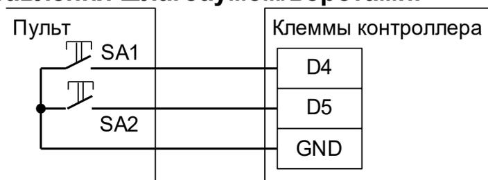
Рисунок 180. Пульт ручного управления шлагбаумом/воротами, кнопка «Стоп» нормально разомкнута.
