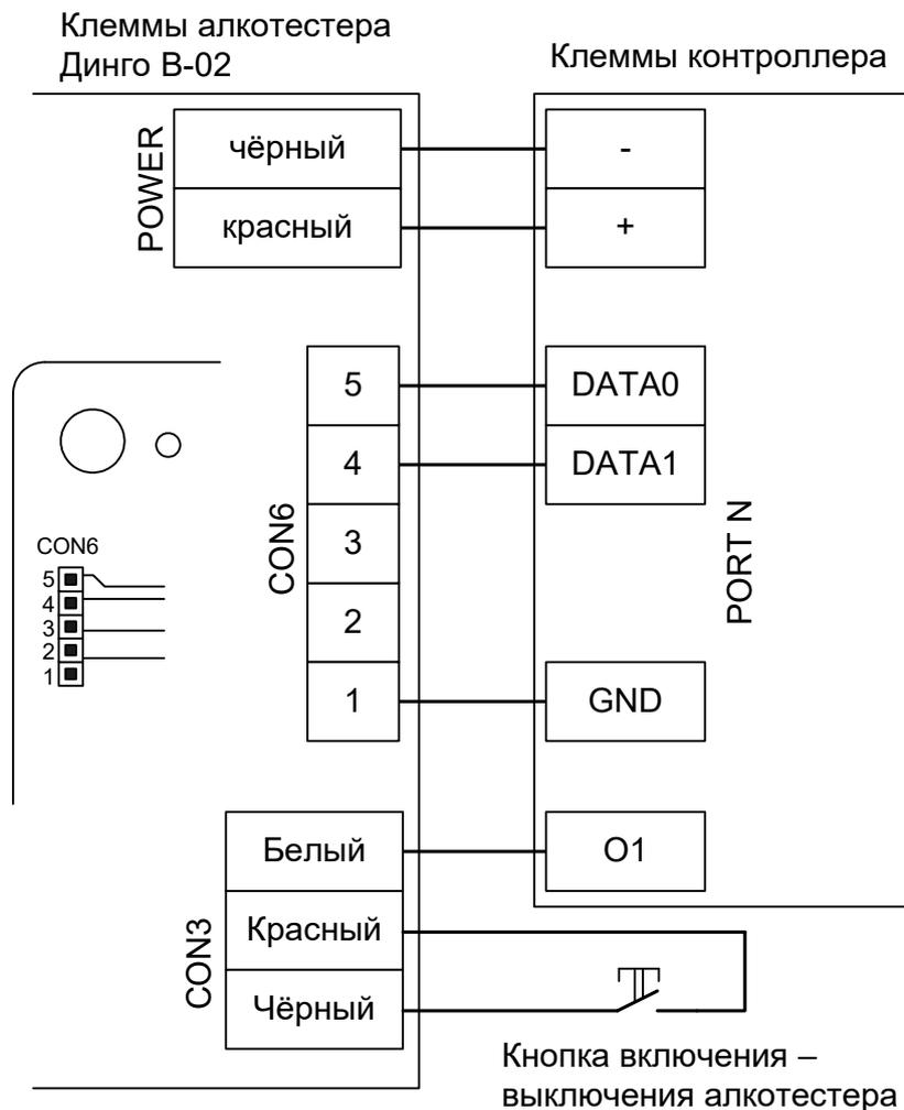
Рисунок 67. Вариант 3 подключения Динго В-02, старая электроника.
