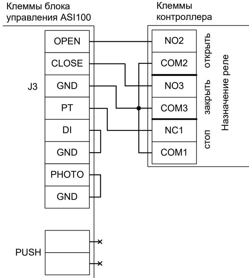
Рисунок 258. Подключение блока управления ворот ASI100.
