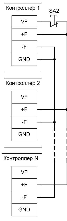
Рисунок 17. Подключение кнопки разблокирования к нескольким контроллерам.
