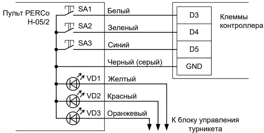
Рисунок 98. Пульт управления PERCo без разъёма.
