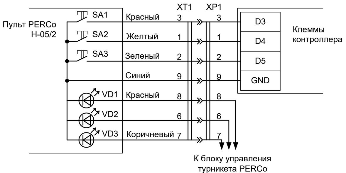
Рисунок 99. Пульт управления PERCo с разъёмом
