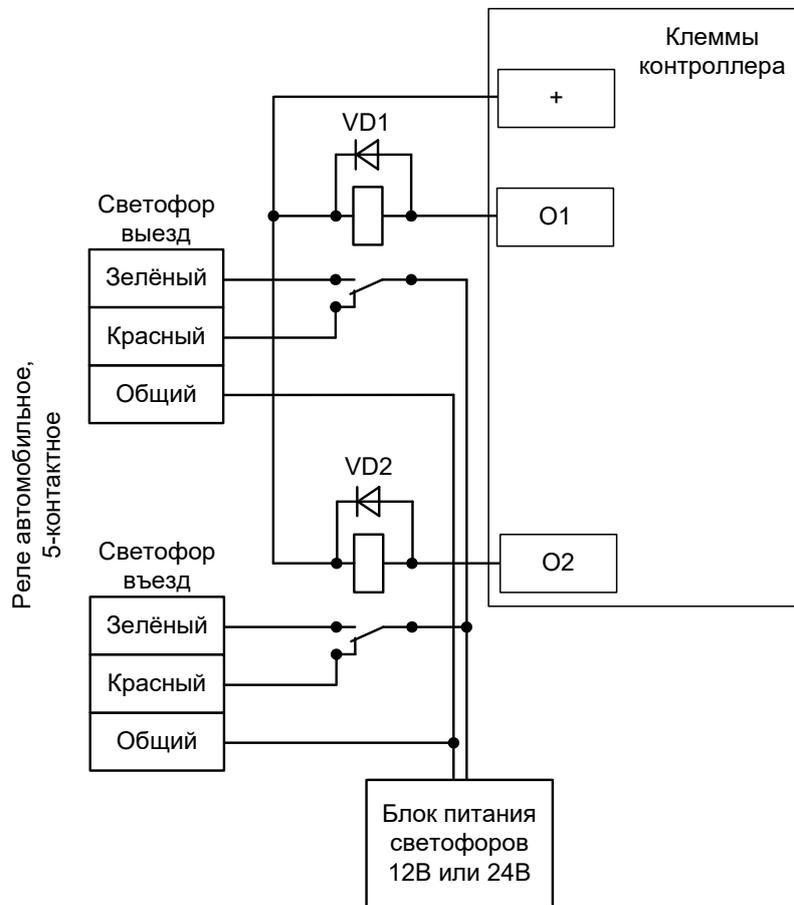
Рисунок 184. Подключение светофоров к внешним реле.
