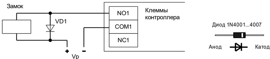
Рисунок 32. Пример подключения электромагнитного замка для первой двери.
