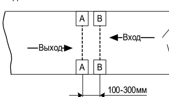
**Рисунок 20. Пример расположения датчиков прохода в коридоре.**
