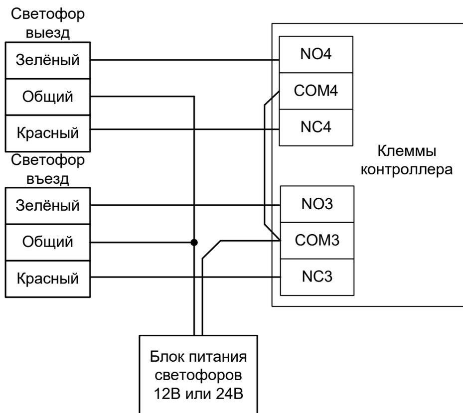
Рисунок 183. Подключение светофоров к внутренним реле.
