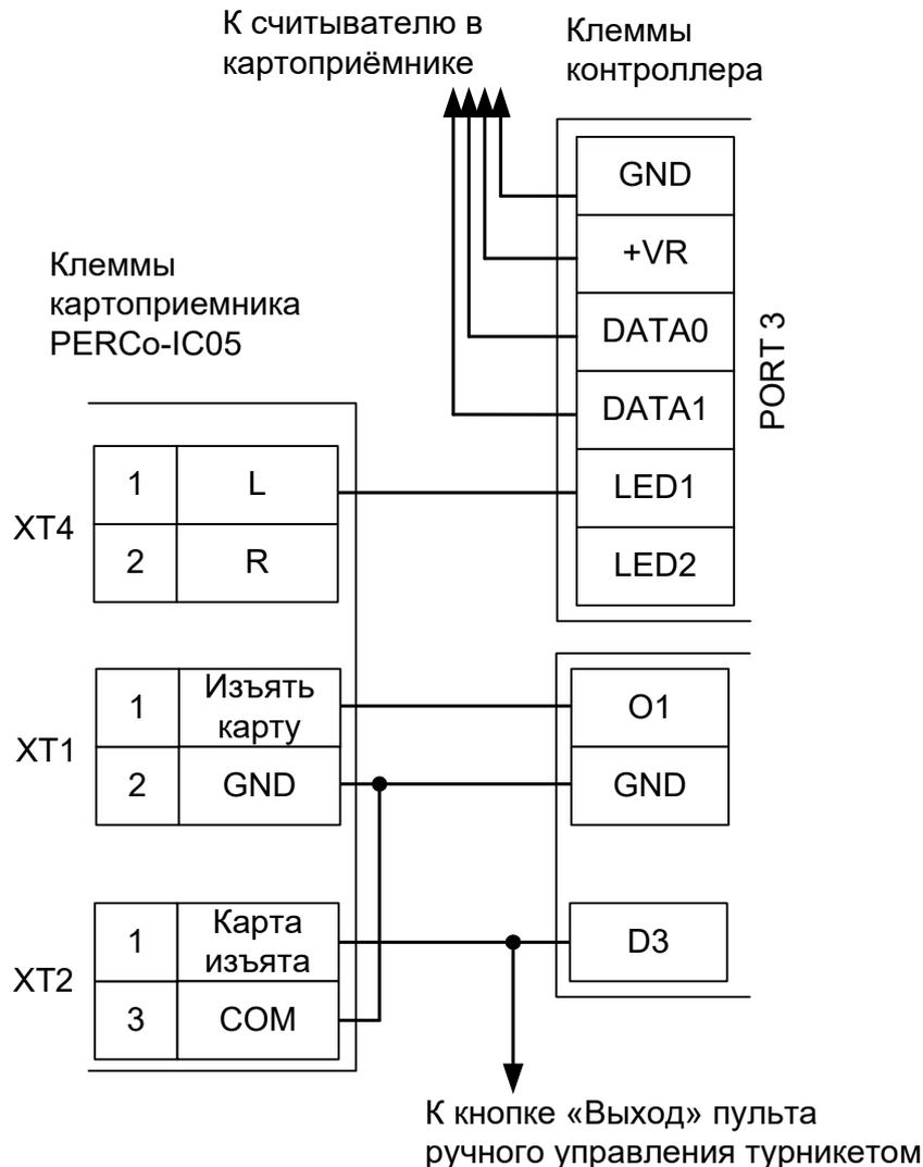
Рисунок 54. Пример подключения PERCo-IC05.
