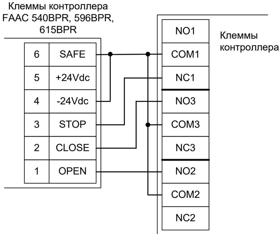
Рисунок 187. FAAC 540BPR, 596BPR, 615BPR.
