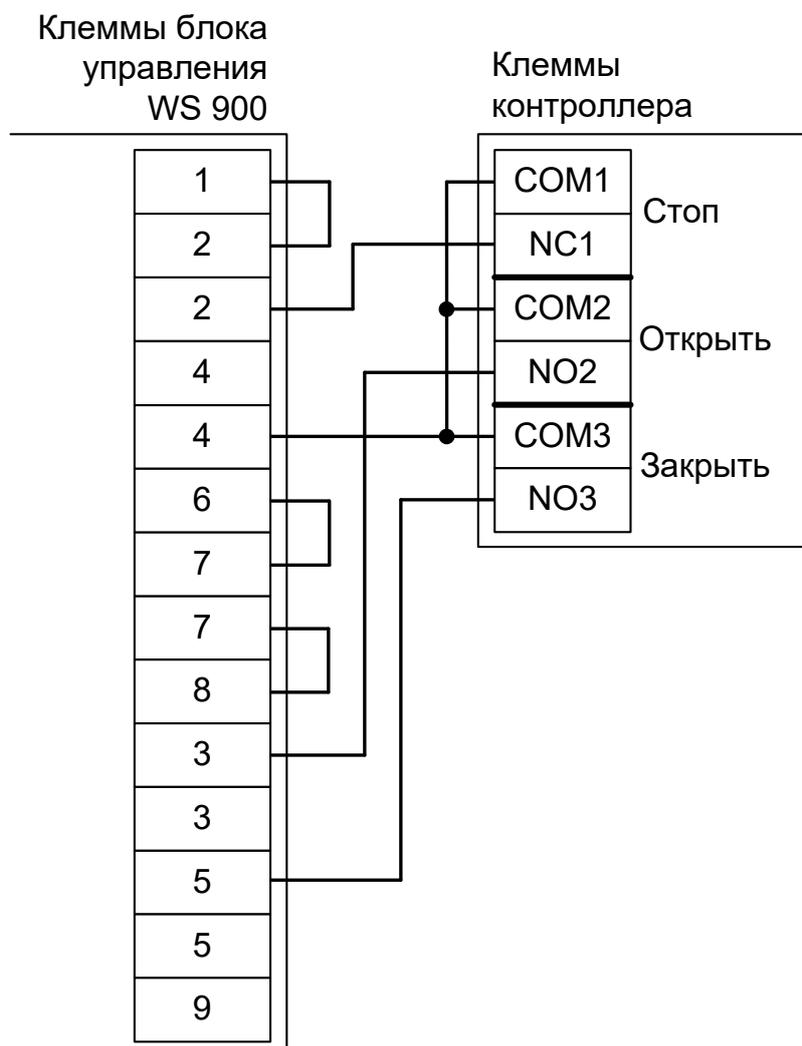
Рисунок 261. Подключение блока управления WS 900.
