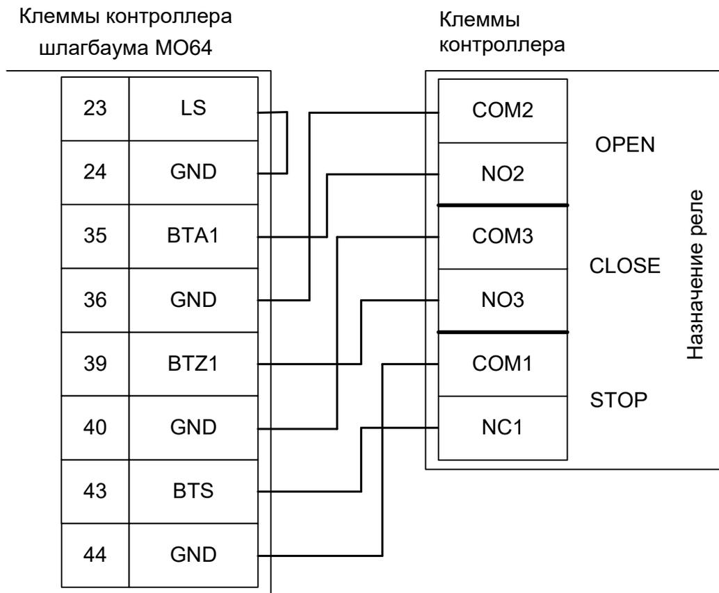
Рисунок 255. Подключение T 3000 – T 3500, P 2000 – P 5000, S 5000 – S 9000.
