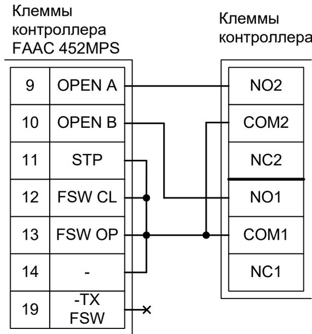
Рисунок 188. FAAC 452MPS.
