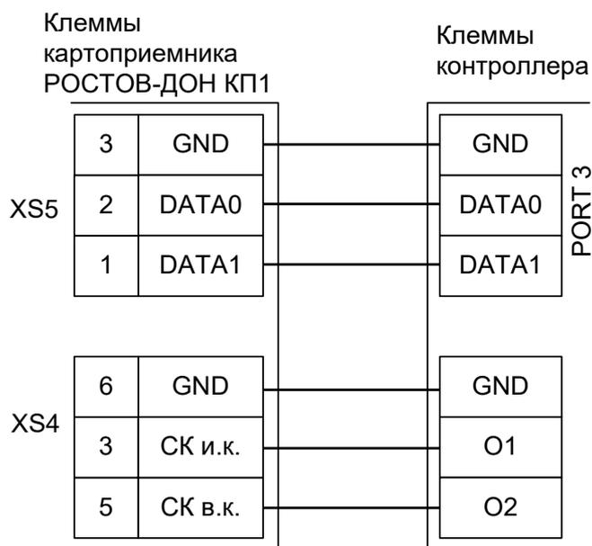
Рисунок 50. Пример подключения Ростов-Дон КП1 в направлении «выход».
