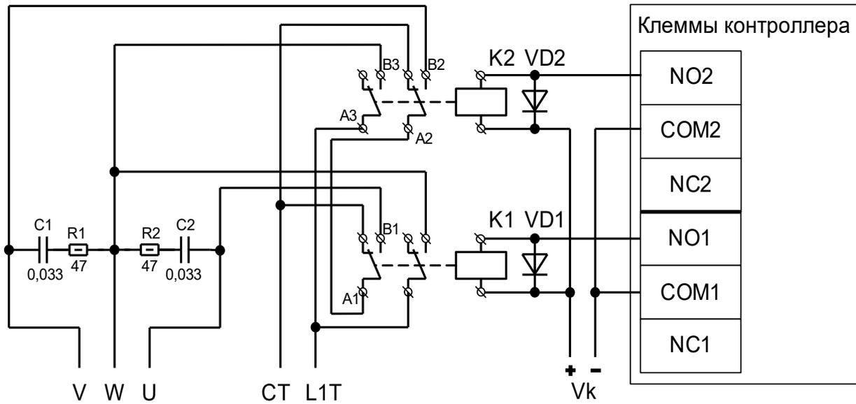
Рисунок 185. Подключение к мотор-редуктору FAST, KRONO, ATI, FERNI.
