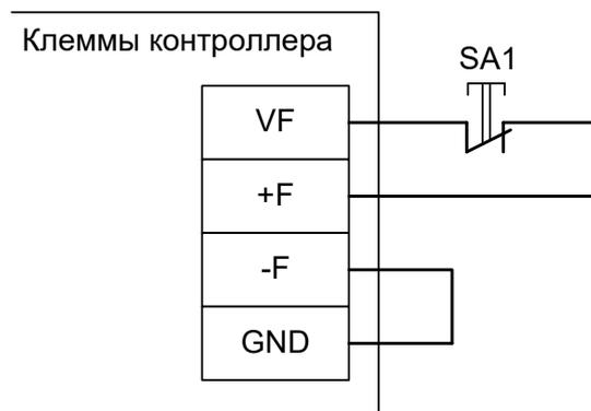
Рисунок 13. Подключение кнопки аварийной разблокировки к одному контроллеру.
