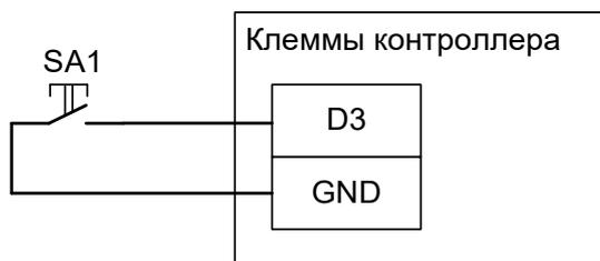
Рисунок 41. Пример подключение кнопки запроса прохода.
