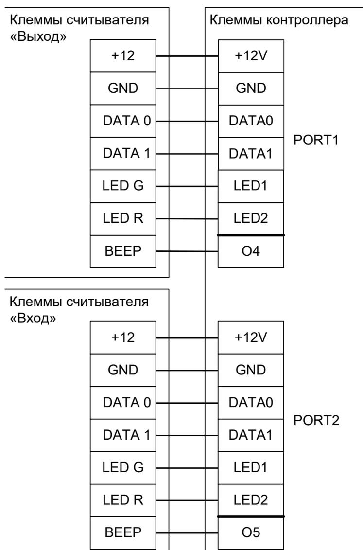
Рисунок 86. Пример подключения считывателей для PERCo-КТ02 и КТ05.3.
