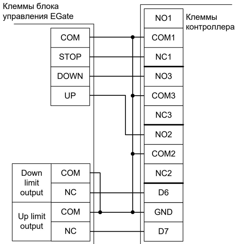
Рисунок 253. Подключение блока управления EGate.
