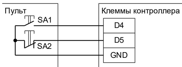
Рисунок 181. Пульт ручного управления шлагбаумом/воротами, кнопка «Стоп» нормально замкнута.
