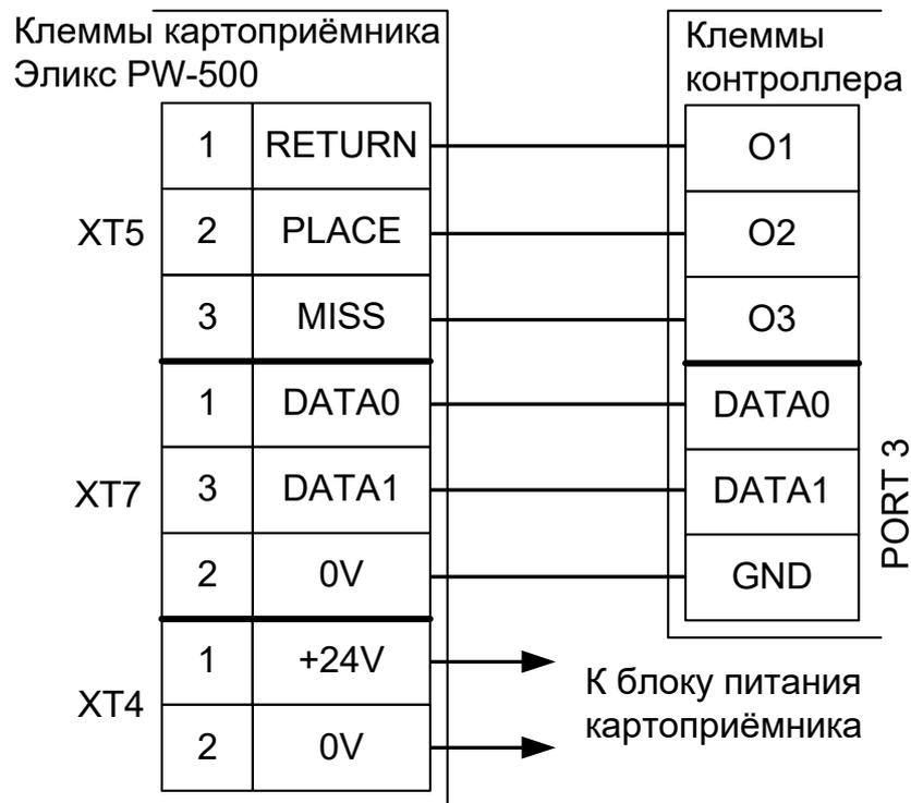
Рисунок 46. Пример подключения Эликс PW-500 нового образца в направлении «выход».
