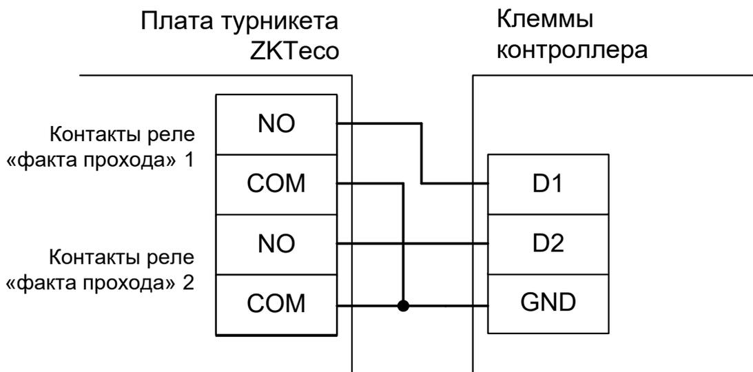
Рисунок 176. Подключение датчиков прохода ZKTeco к контроллеру вариант №1.
