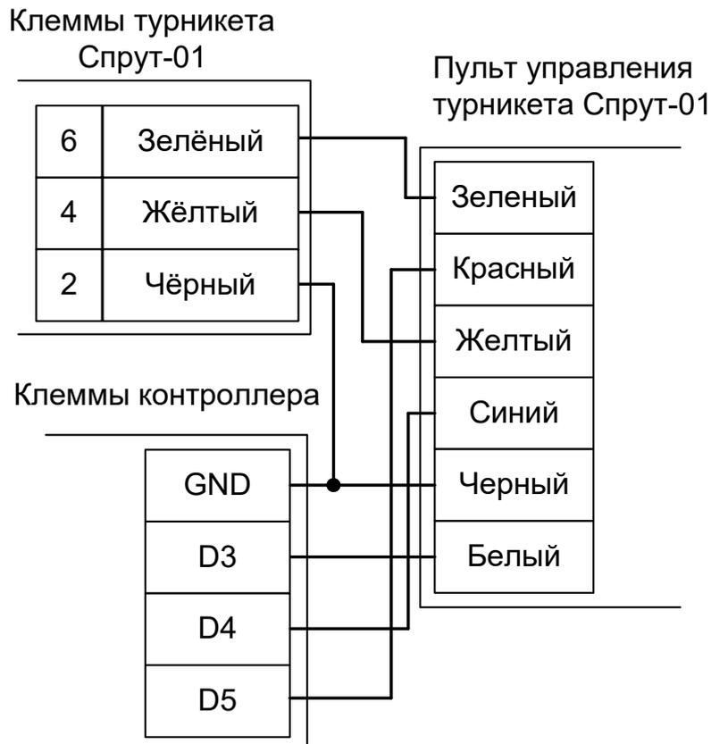
Рисунок 151. Первый вариант подключения пульта управления «Спрут-01».
