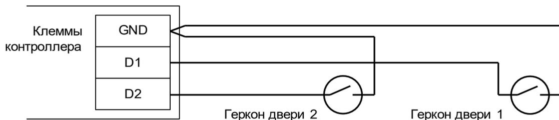
Рисунок 40. Подключение датчиков открытия дверей.
