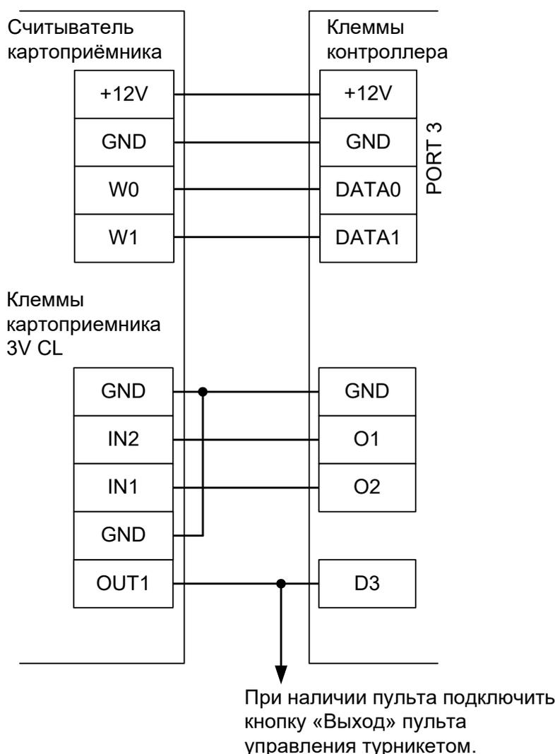
Рисунок 62. Пример подключения картоприёмника 3V CL к контроллеру .
