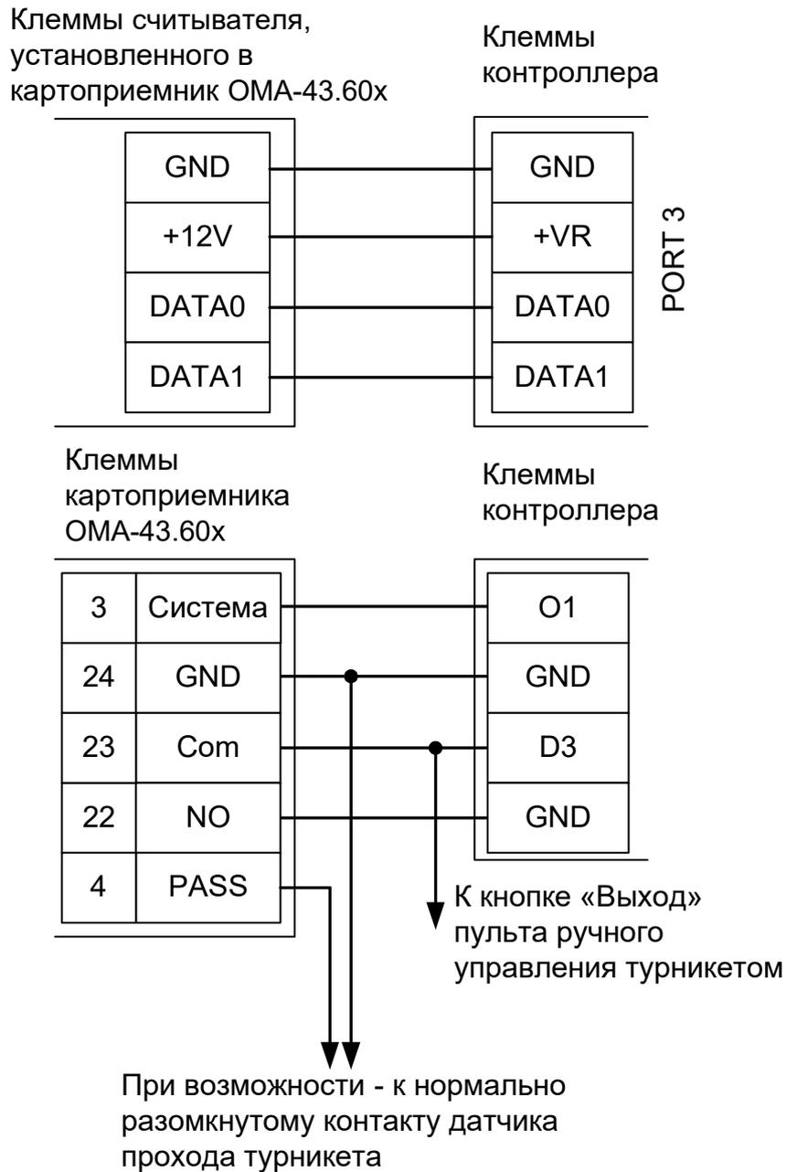
**Рисунок 48. Пример подключения ОМА-43.60х в направлении «выход».**
