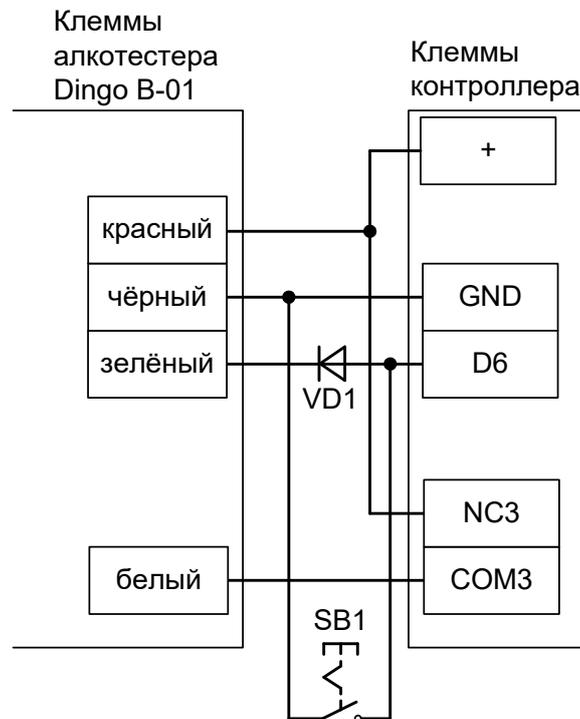
VD1 – диод Шотки или германиевый (с минимальным падением напряжения).
