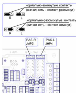
Рисунок 106. Перемычки JMP3 и JMP4 контроллера ОМА 264MC1.
