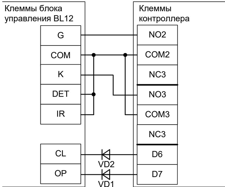
Рисунок 249. BL12 с использованием концевых датчиков.
