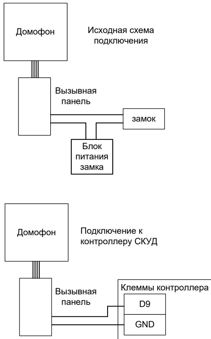
Рисунок 43. Подключение домофона с «сухим контактом» реле.
