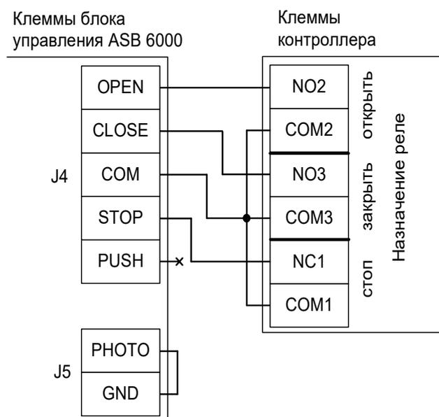
Рисунок 257. Подключение блока управления шлагбаума ASB6000.
