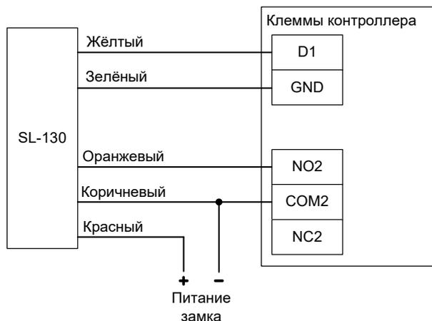
Рисунок 36. Пример подключения замка SL-130 для первой двери.
