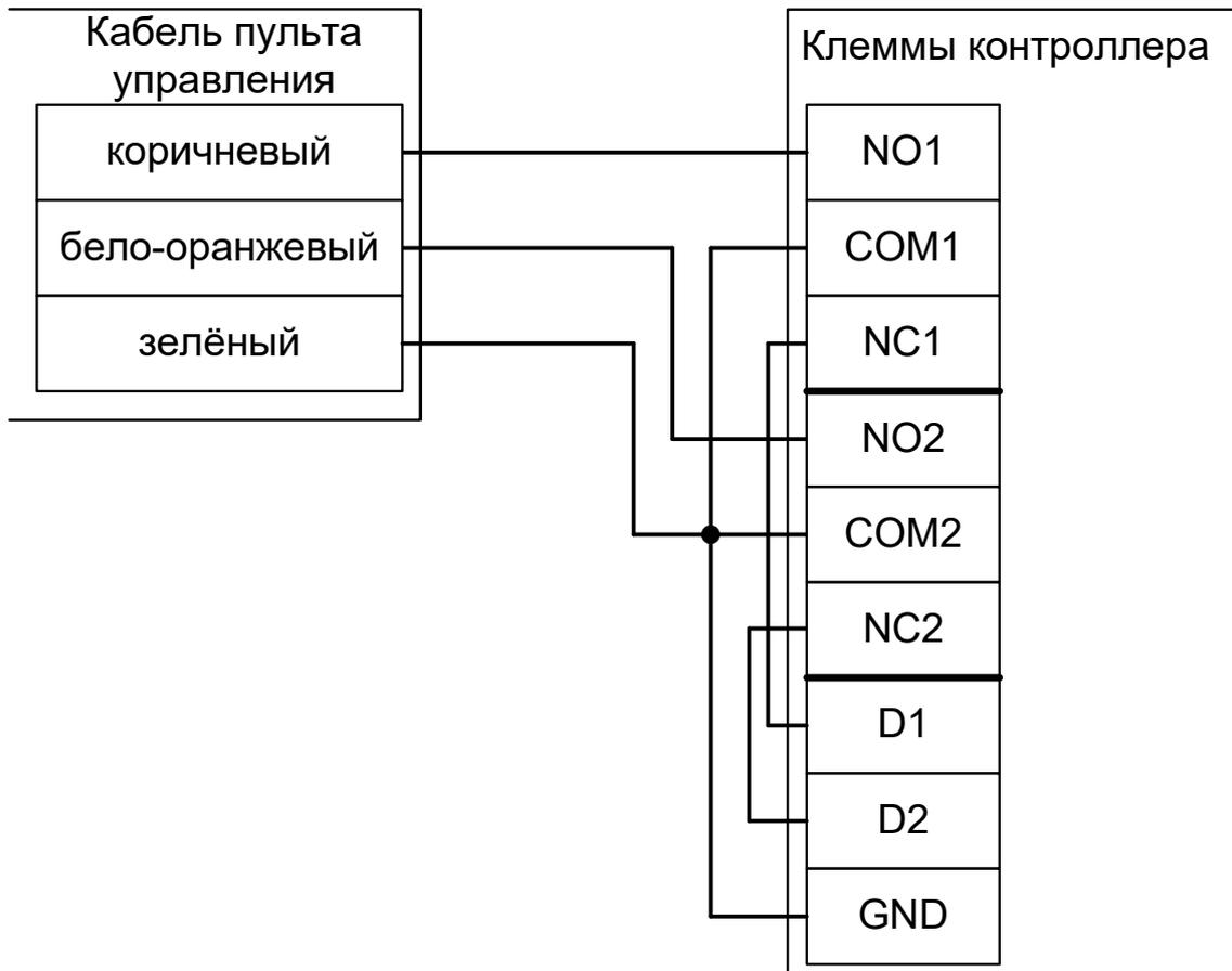
Рисунок 121. Автоматические калитки «Ростов–Дон», новый вариант.
