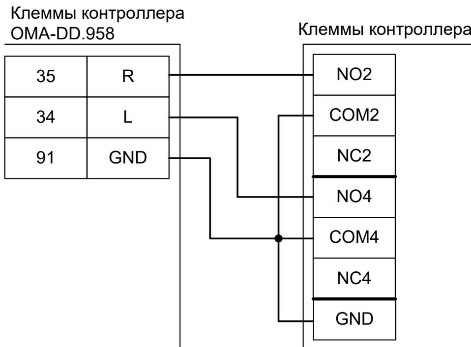
Рисунок 109. ОМА 36.68 с контроллером ОМА-DD.958.
