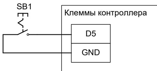
Рисунок 42. Пример подключения кнопки блокировки
