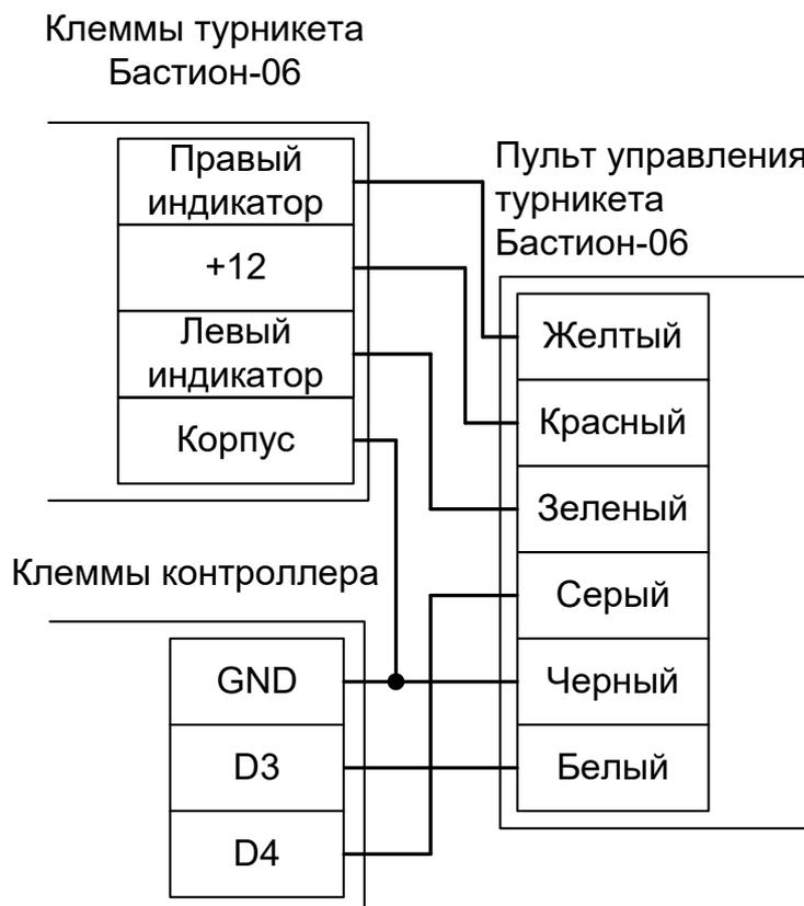
Рисунок 124. Первый вариант подключения пульта управления «Бастион-06» и «Бизон».
