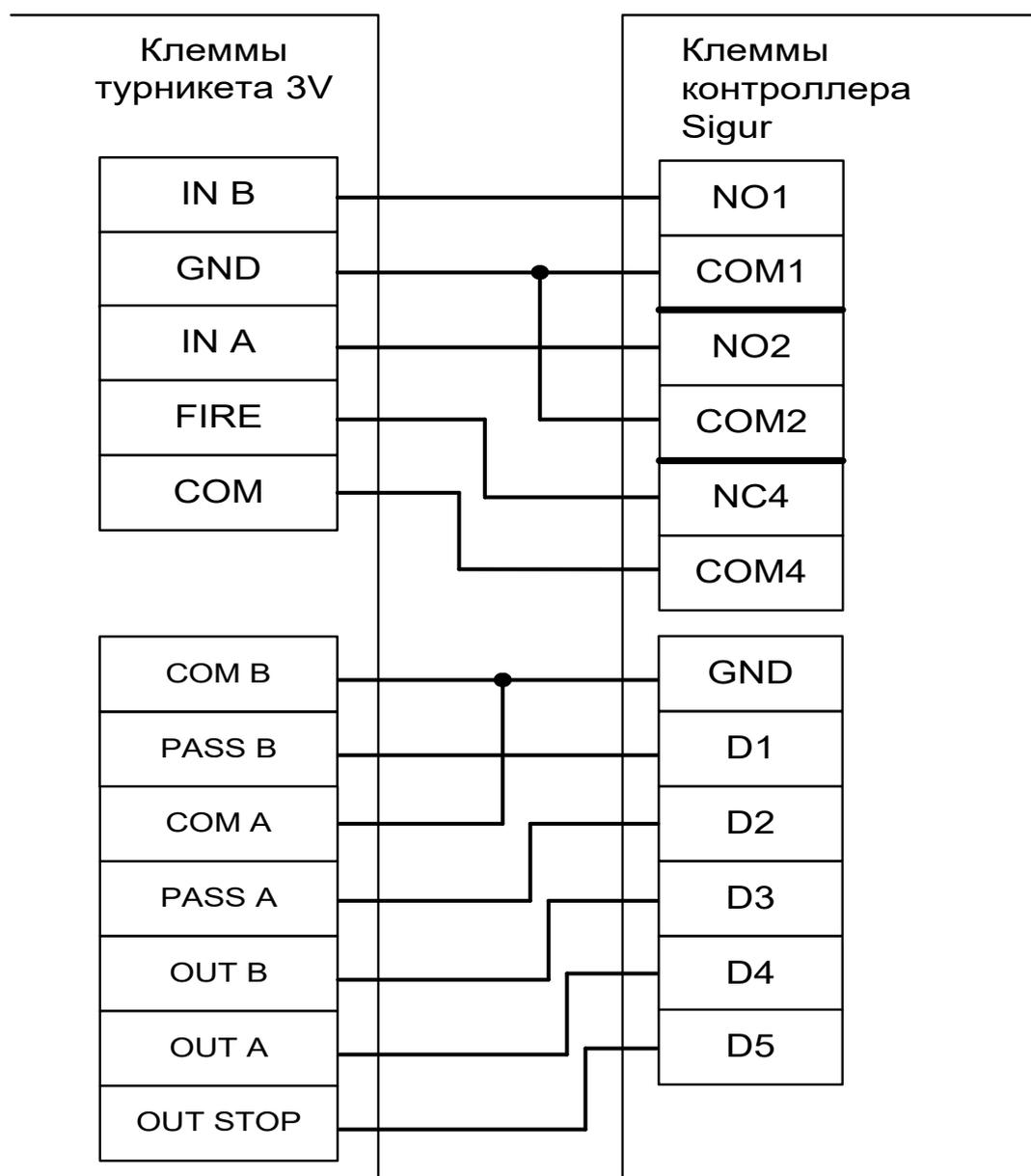
Рисунок 179. Подключение турникета 3V к контроллеру с помощью разъёмов на лицевой стороне платы управления турникета.
