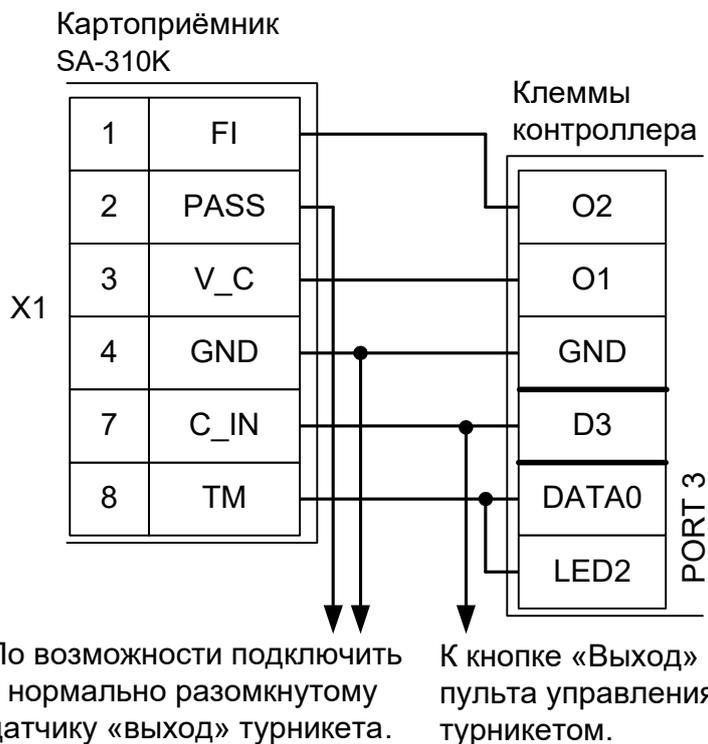
**Рисунок 61. Пример подключения SA-310K на выход турникета.**
