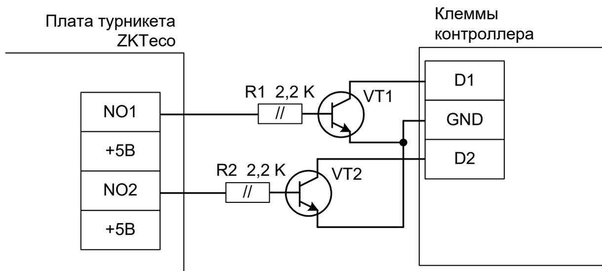
Рисунок 177. Подключение датчиков прохода ZKTeco к контроллеру вариант №2.
