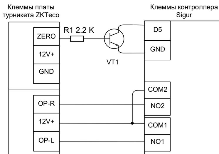
Рисунок 178. Подключение турникета ZKTeco FHT2300 к контроллеру.
