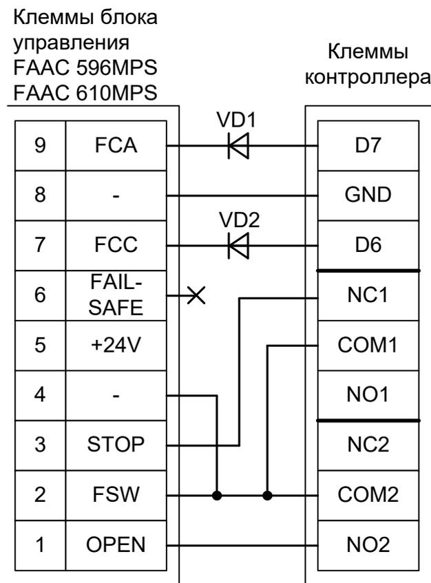
Рисунок 186. FAAC 596MPS, FAAC 610MPS.
