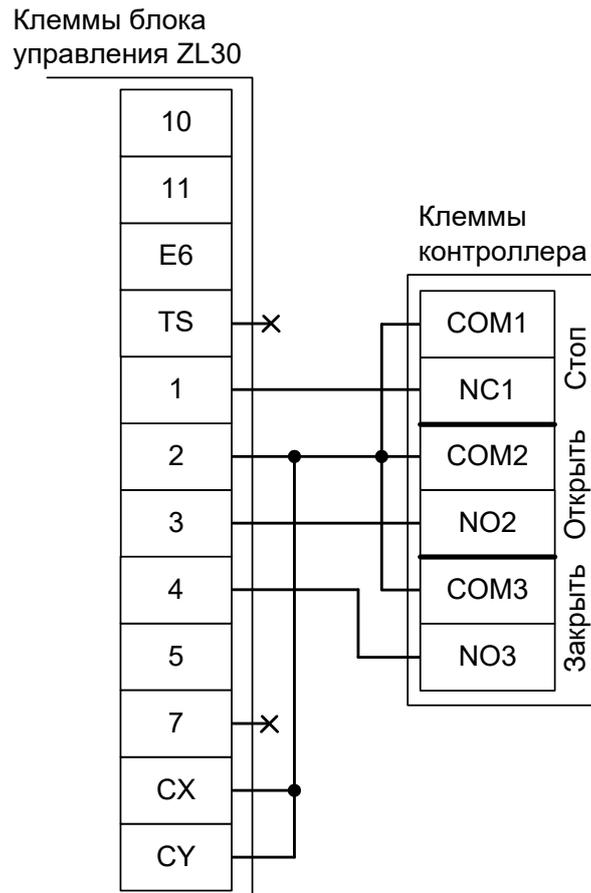
Рисунок 221. ZL30 с импульсным управлением.
