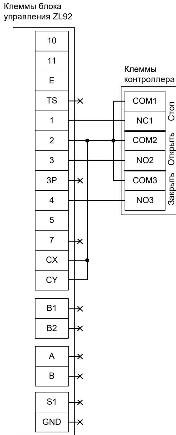
Рисунок 219. ZL92 с импульсным управлением.
