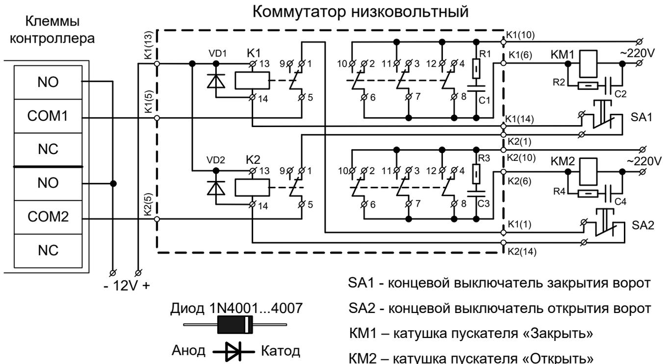
Рисунок 236. Подключение к приводу ворот, управляемому двумя электромагнитными пускателями.
