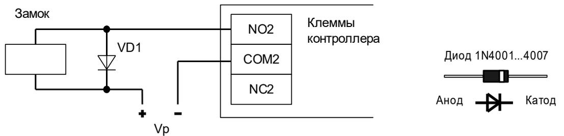
Рисунок 33. Пример подключения электромеханического замка для первой двери.
