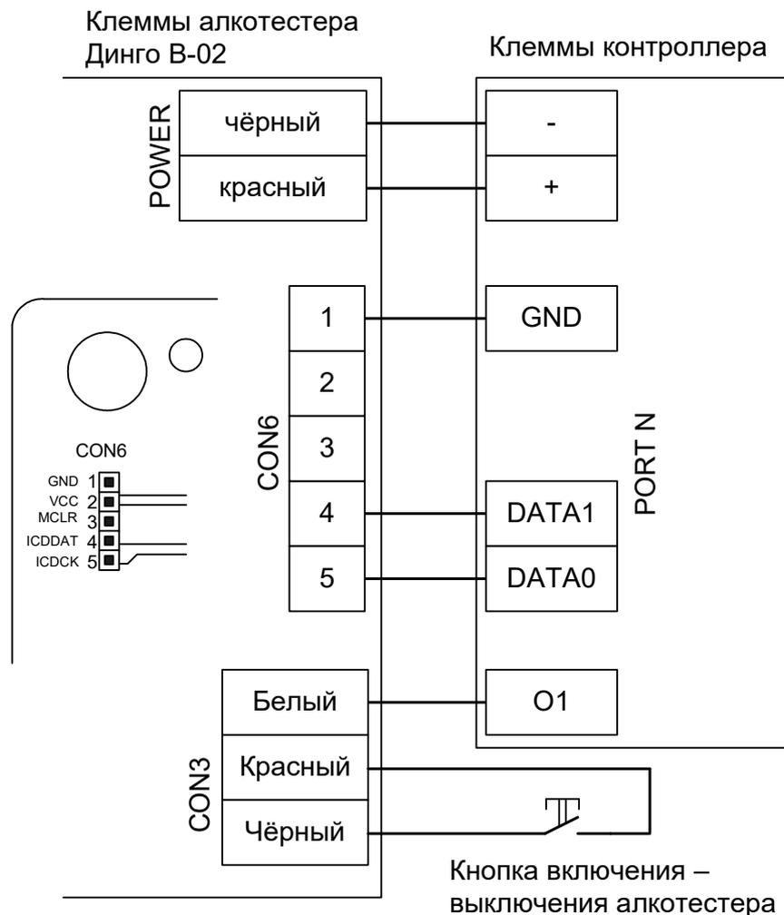
**Рисунок 66. Вариант 2 подключения Динго В-02, новая электроника.**
