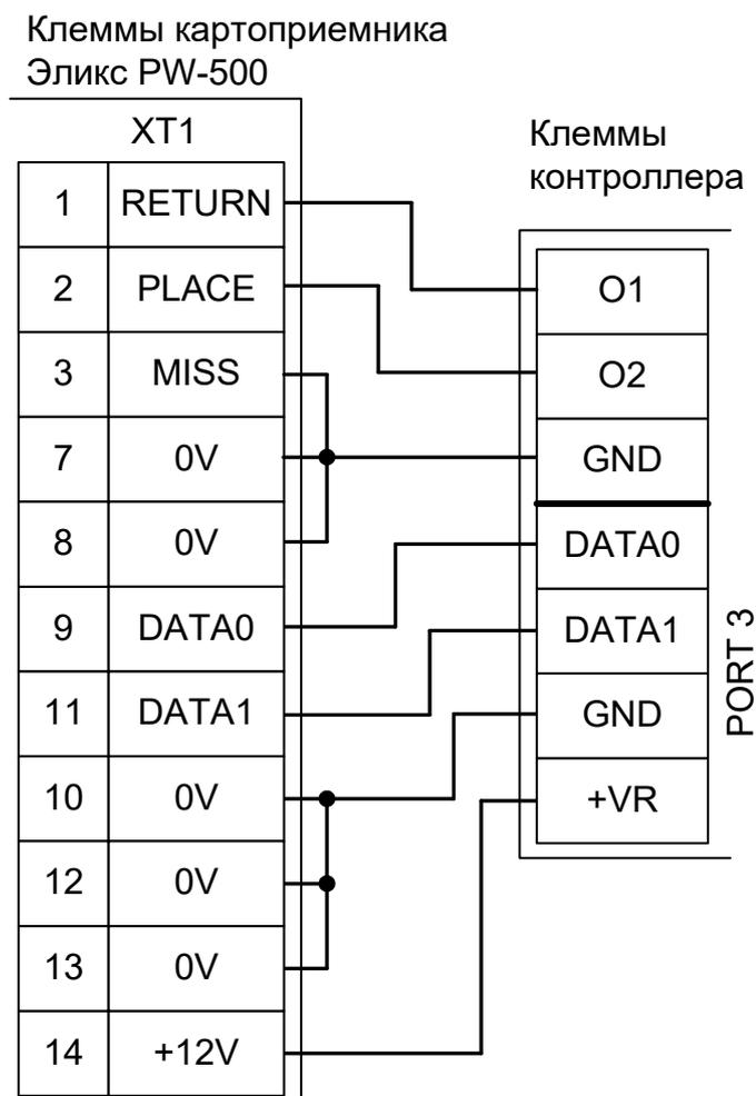
**Рисунок 47. Пример подключения Эликс PW-500 старого образца в направлении «выход».**
