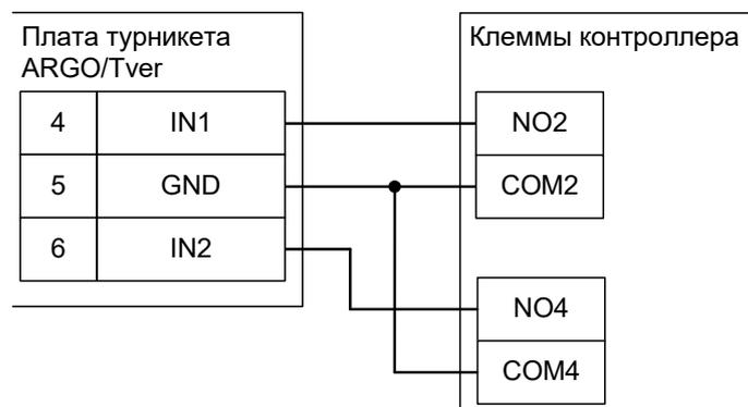
Рисунок 148. ARGO/Tver, упрощённый вариант.
