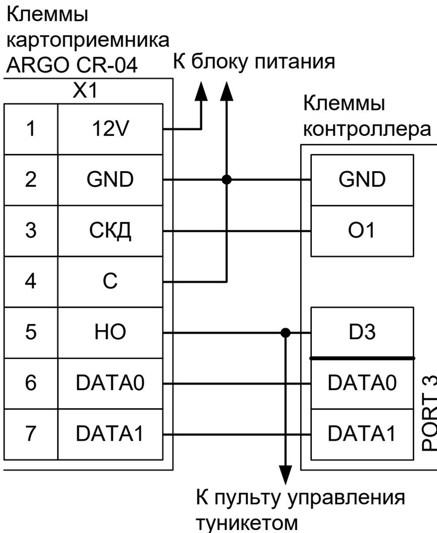
Рисунок 52. Пример подключения ARGO CR-04 в направлении «выход».
