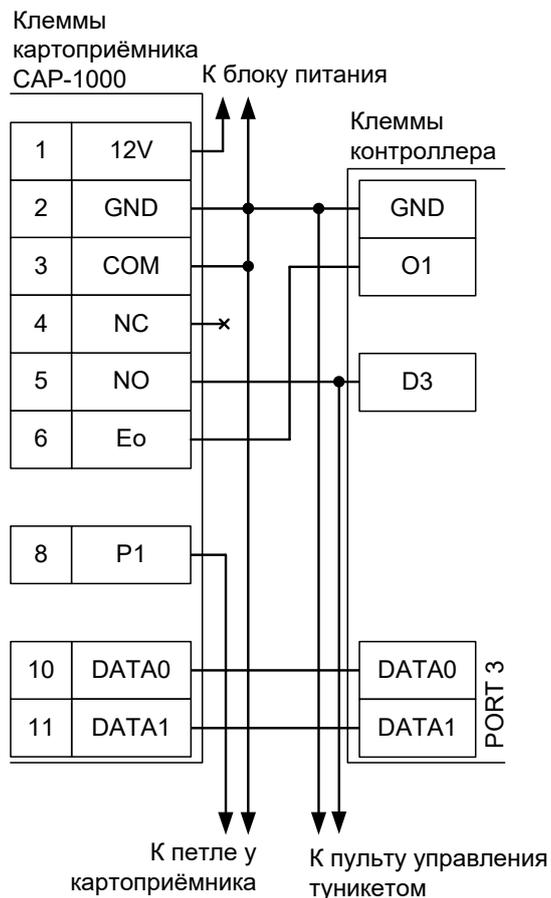
Рисунок 59. Пример подключения ParkFactor CAP-1000 в направлении «выход».
