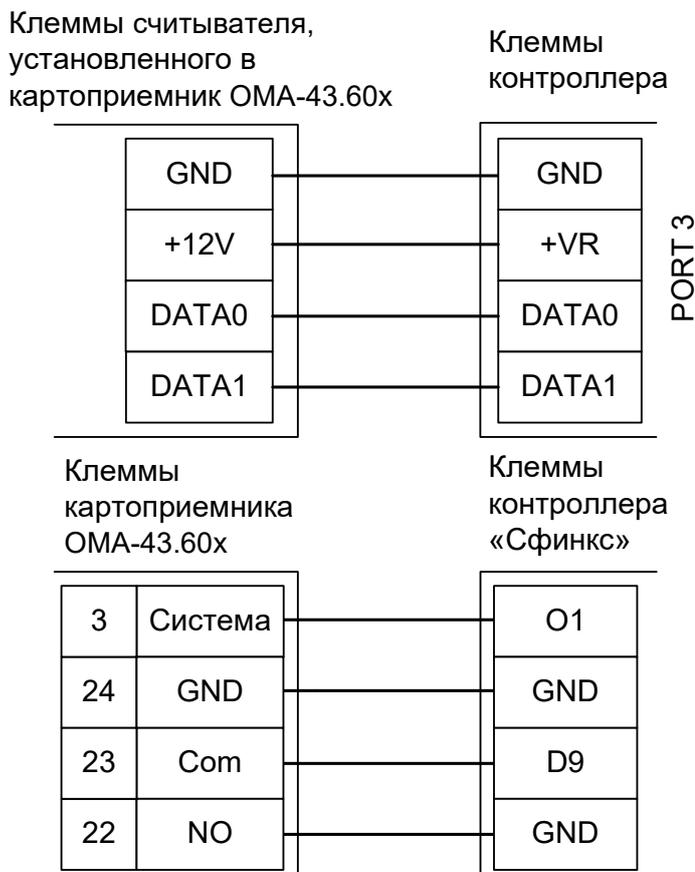
Рисунок 49. Пример подключения ОМА-43.60х на выход первой двери.
