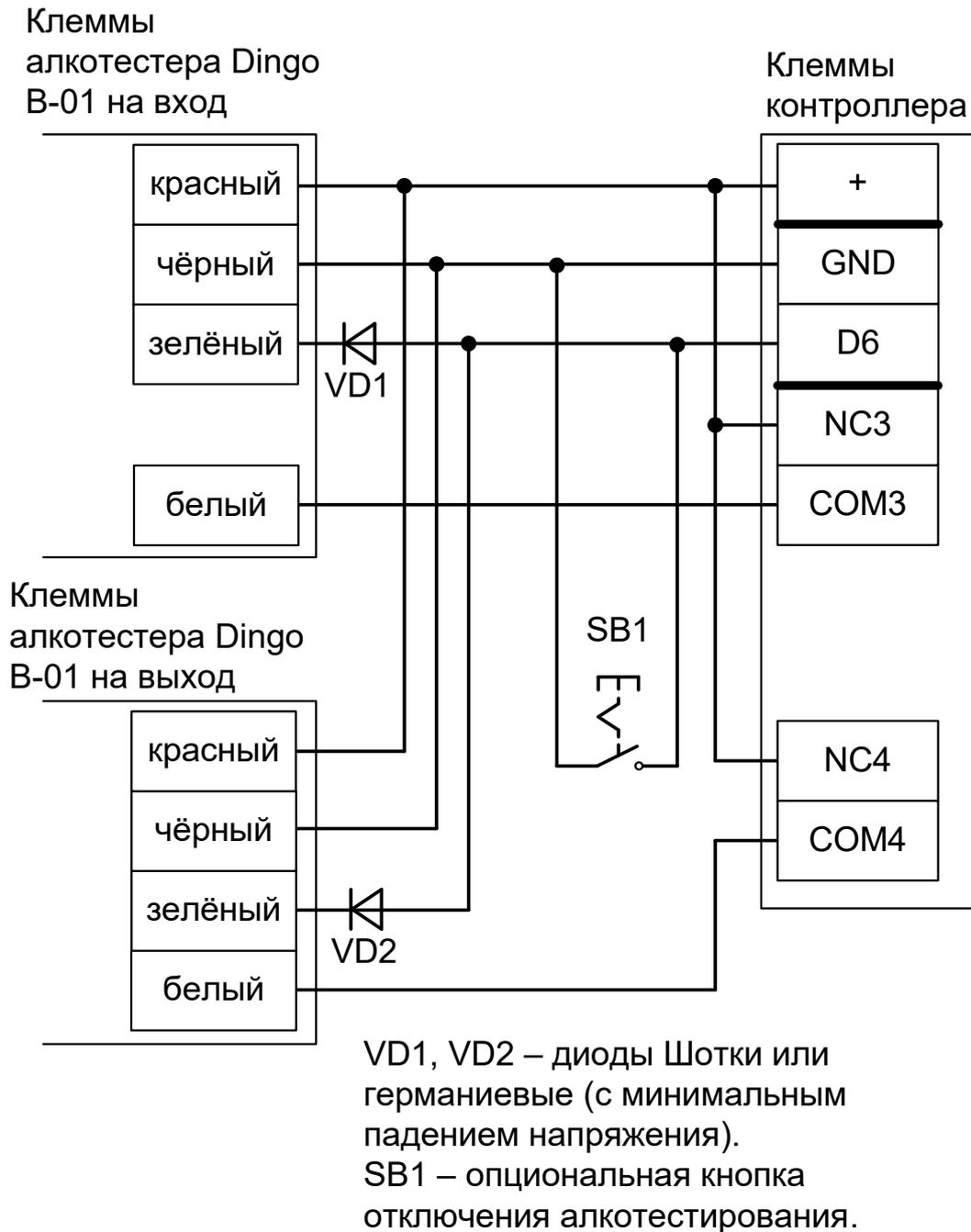
**Рисунок 64. Вариант подключения двух Динго B-01 к турникету.**
