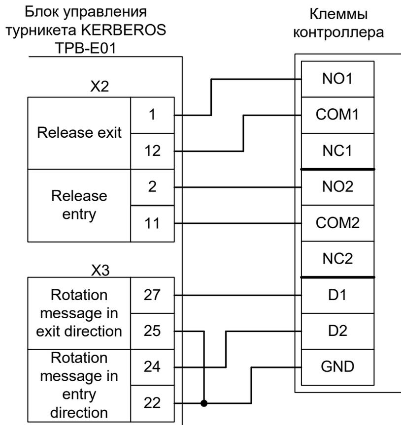
Рисунок 152. КАВА Kerberos TPB-E01 с платой SINA 2.0.
