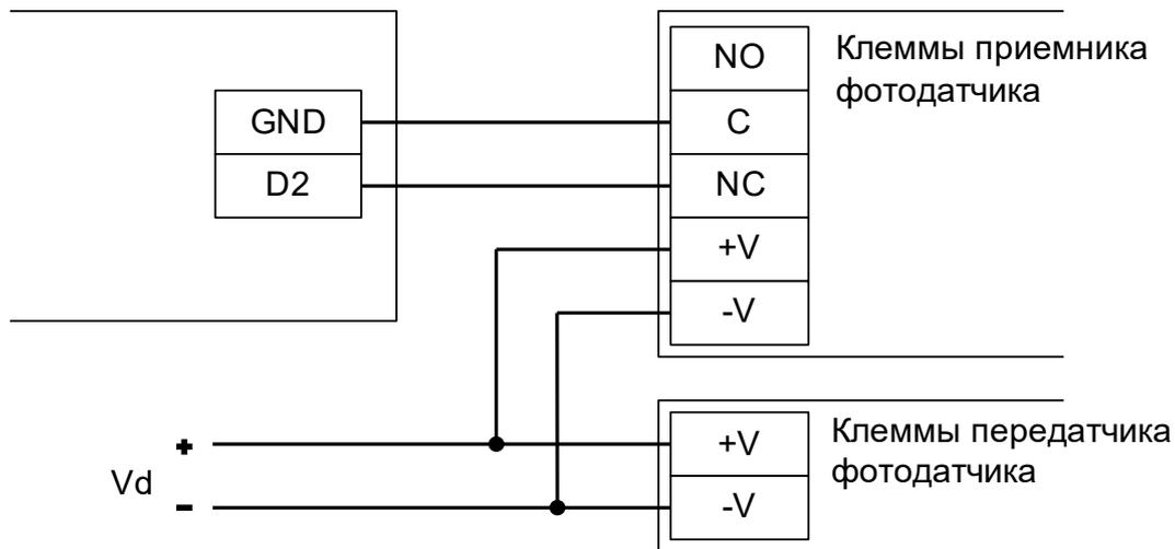
Рисунок 182. Пример подключение фотодатчика типа ДОС на примере центрального датчика.
