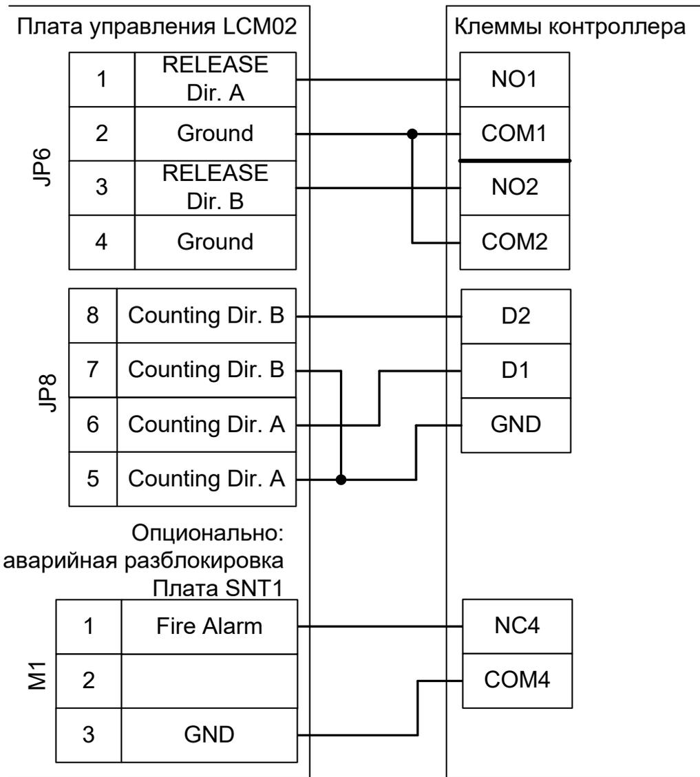
Рисунок 142. Gunnebo LCM02.
