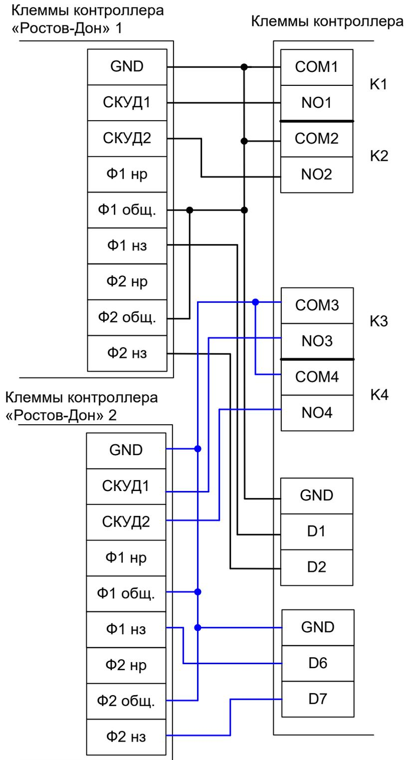
Рисунок 122. Пример подключения двухпроходного турникет «Ростов-Дон».
