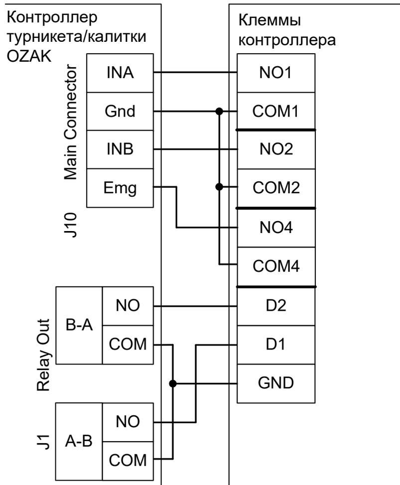
Рисунок 163. OZAK GLASS LINE GL A3, GL A1.
