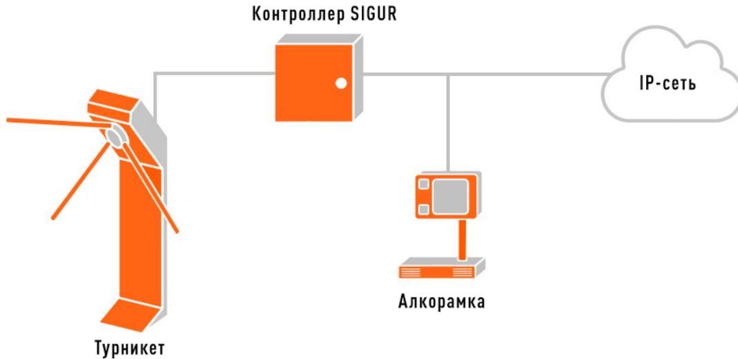
Рисунок 69. Пример схемы подключения Алкорамки в Sigur.
