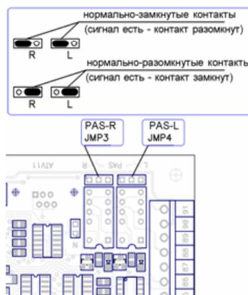
Рисунок 101. Перемычки JMP3 и JMP4 контроллера ОМА–DD.958, ОМА 264MC1, 866.MC2.
