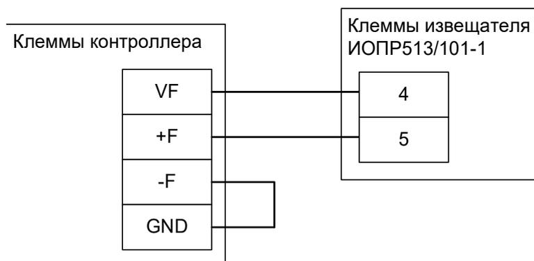
Рисунок 14. Подключение охранно-пожарного извещателя ИОПР513/101-1 к одному контроллеру.
