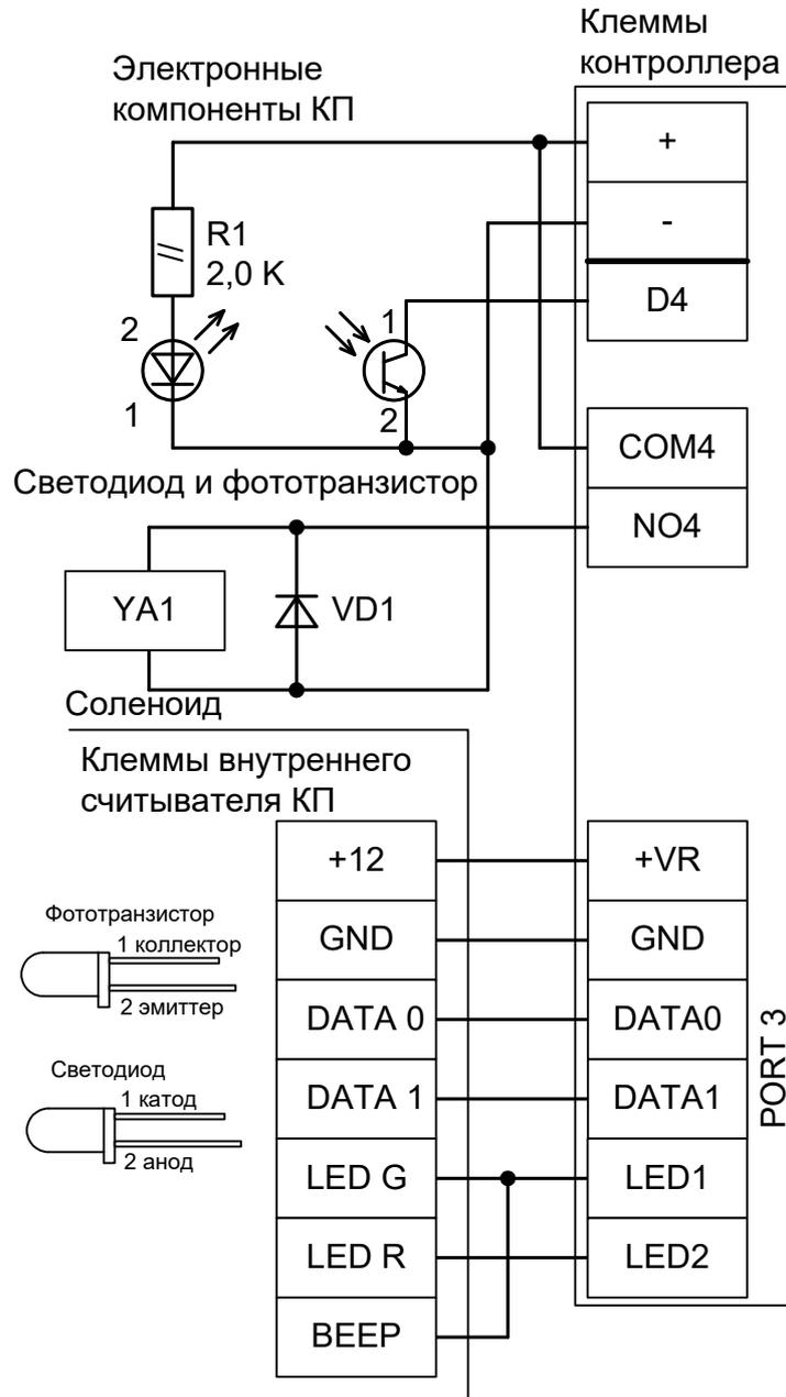
Рисунок 60. Пример подключения ParkFactor CAP-1000 на выезд для шлагбаума.
