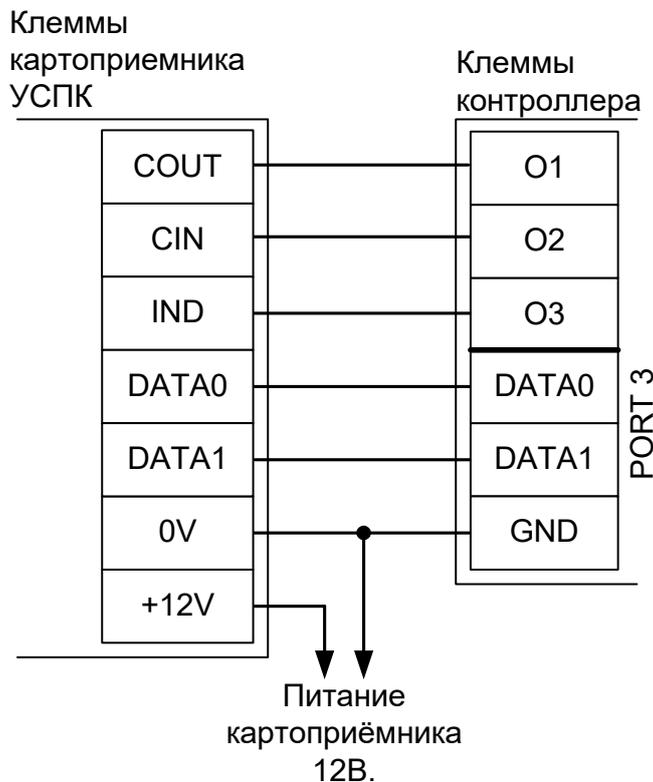
Рисунок 57. Пример подключения УСПК в направлении «выход».
